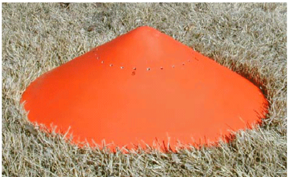
La sonda HITPR, inventada per Tim Samaras, es col·loca allí on es preveu que passi el tornado per mesurar la pressió atmosfèrica, el vent, la temperatura i la humitat relativa.
